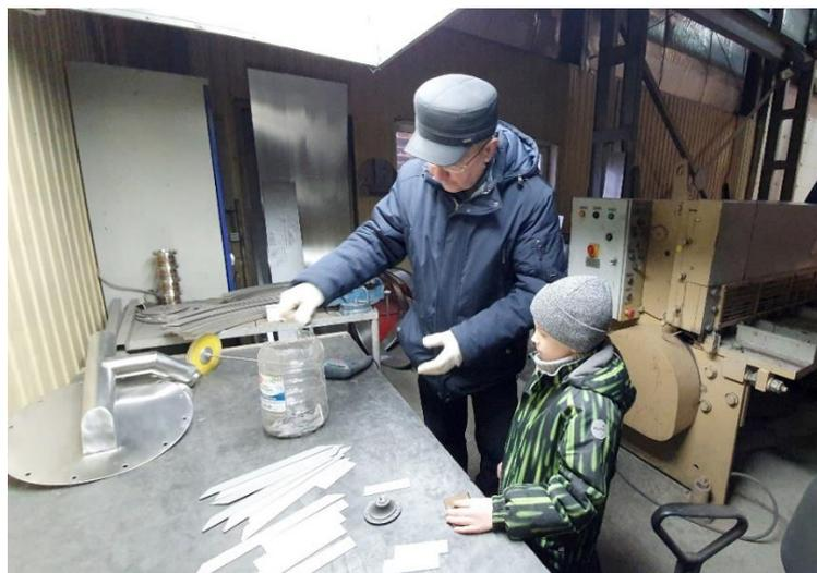
На фотографии представлены детали, которые после резки на гильотине шлифуются специальной шлифовальной машинкой
